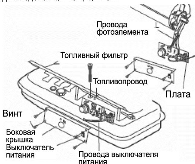
Снять боковую крышку, отсоединить топливопровод от топливного фильтра. Повернуть топливный фильтр против часовой стрелки на 90°, потянуть его на себя и вынуть. Промыть фильтр керосином и установить обратно. Присоединить топливопровод и установить обратно боковую крышку.
