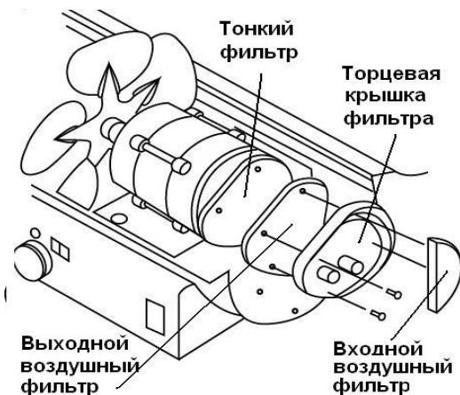
Очищать по мере необходимости, но не реже 1 раза в год. Снимите верхний кожух. Ослабьте винт, удерживающий лопасти на валу и снимите лопасти. Очистите лопасти вентилятора мягкой тканью смоченной в керосине или растворителе. Просушите лопасти и установите обратно на вал. Закрутите плотно винт, установите верхний кожух. При несвоевременной очистке лопастей, появляется дисбаланс вентилятора, что приводит его к выходу из строя.
